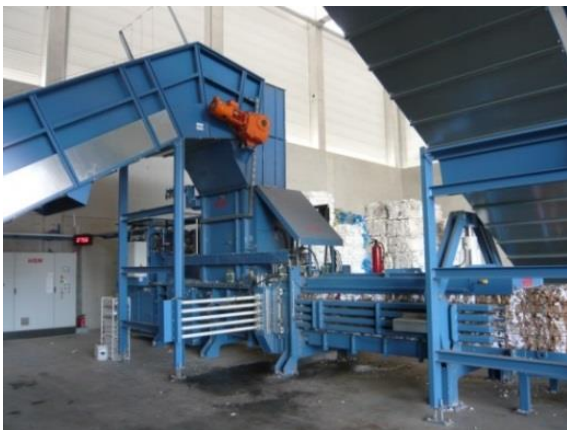
Abbildung 3: Sortieranlage und Kanalballenpresse Deißlingen
